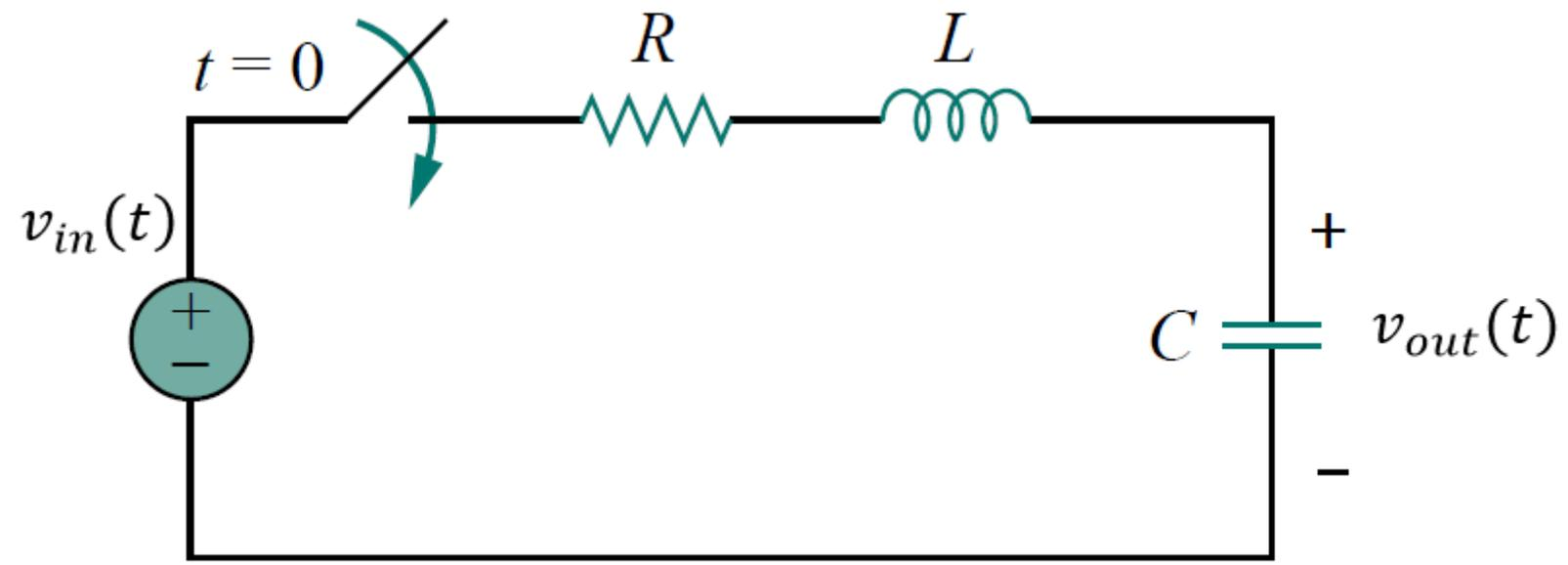
**Exercício:** Encontre a frequência de Neper a frequência angular do circuito RLC em série. Calcule a função transferência.
